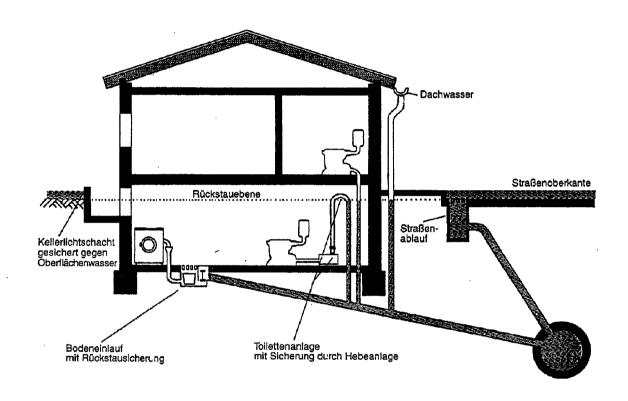
**5.** Dränagen dürfen nie an Misch- oder Schmutzwasserkanäle angeschlossen werden (DIN 1986, Teil 3). Sofern ein Anschluß an einen Regenwasserkanal oder einen freien Vorfluter (Gewässer) erfolgt, ist auch hier eine Rückstausicherung unerläßlich (DIN 4095).
